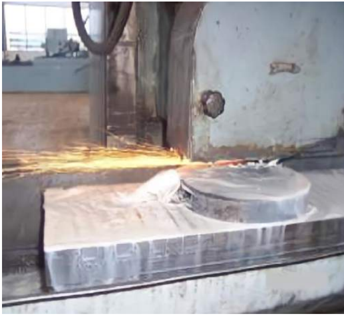
Rectificado de placas de la industria cerámica y cortinas de válvulas petroleras.
