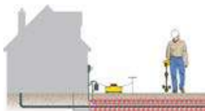
Conecte directamente a acometidas de servicios públicos.
